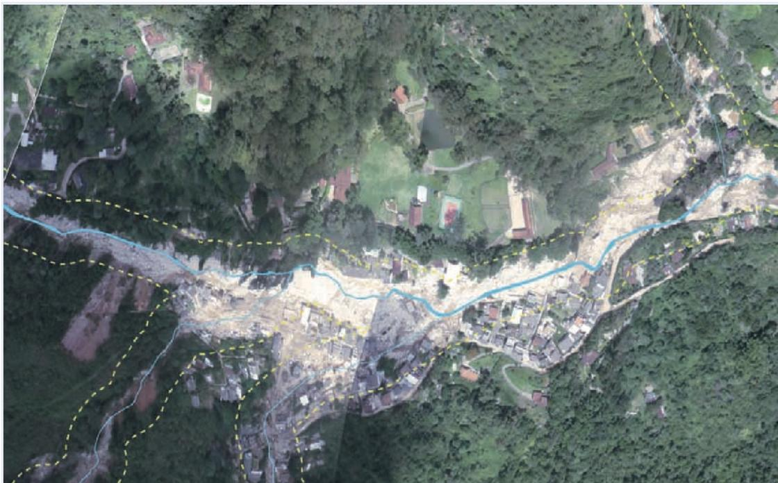
Figura A, no alto: Imagem Google Earth de 30.08.2010, antes da tragédia. Figura B, embaixo: Foto aérea de 26.01.2011, mostrando os efeitos da inundação e corrida de lama sobre as casas e edificações. Nota-se claramente que a área mais afetada é aquela inserida na faixa de APP de 30 metros em cada lado dos cursos d'água.
